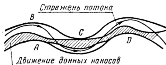
Рисунок 5.2 - Движение донных наносов на изгибе реки
